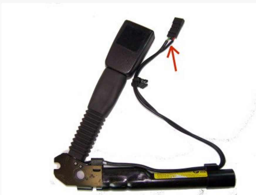
ZULEITUNG AM GURTSCHLOSS
